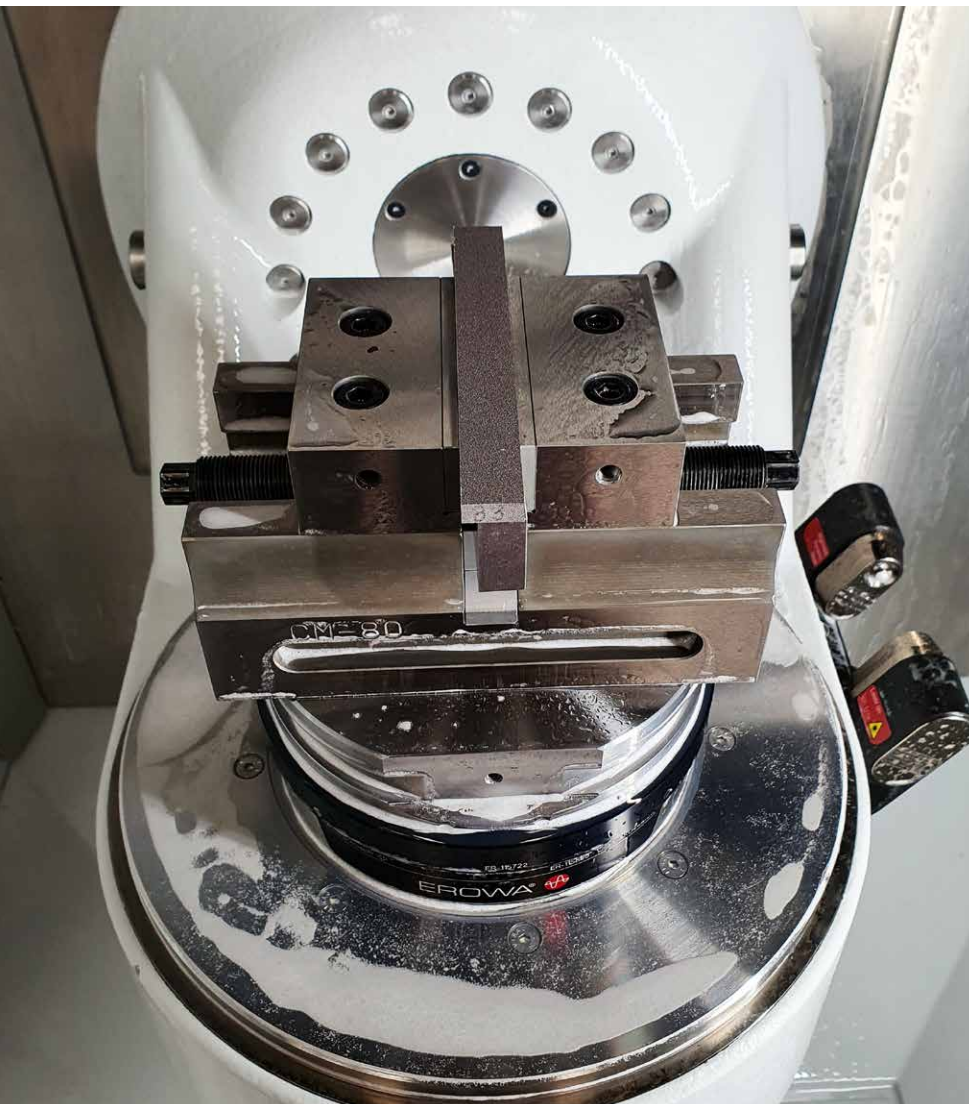
Die 3D-gedruckte Zugprobe vor der mechanischen Nachbearbeitung auf dem 5-Achs-Bearbeitungszentrum «Micro HD».
